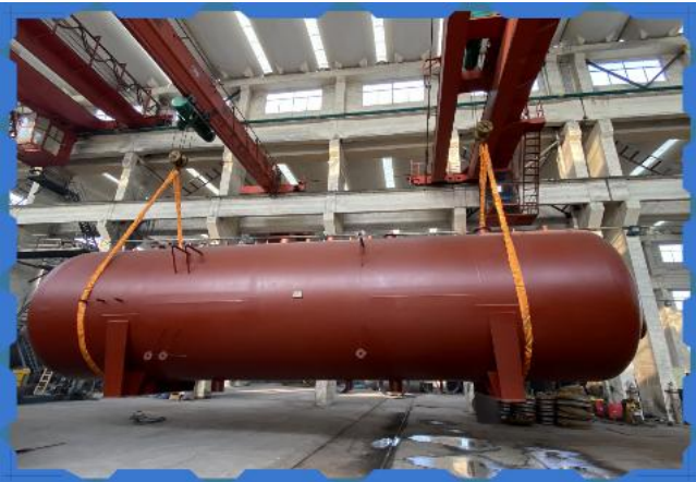
华光锅炉除氧器
